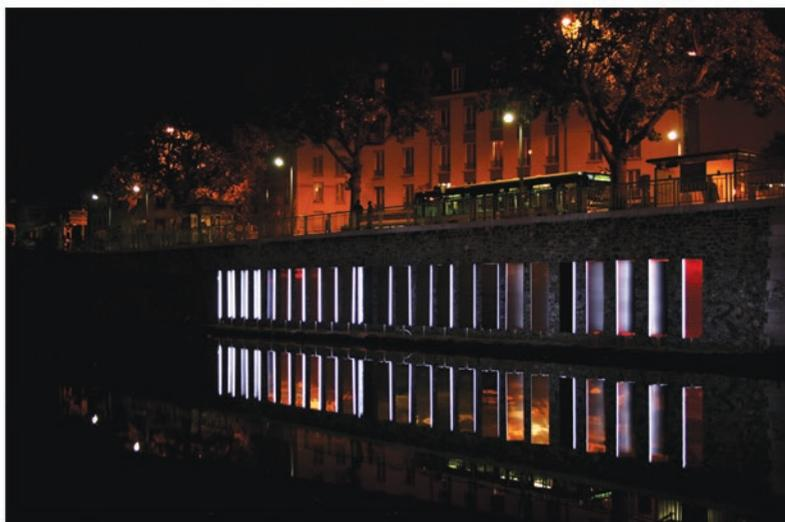
L'installation 'Binary Waves' est constituée d'une série de panneaux cinétiques et lumineux de 3 mètres de haut et de 60 centimètres de large, espacés à distance régulière. Les panneaux tournent sur leur axe vertical, dévoilant une surface noire réfléchissante d'un côté, argentée et mate de l'autre côté. Leurs mouvements créent des effets optiques d'alternance entre illumination de l'environnement et la réflexion de celui-ci dans les panneaux.
